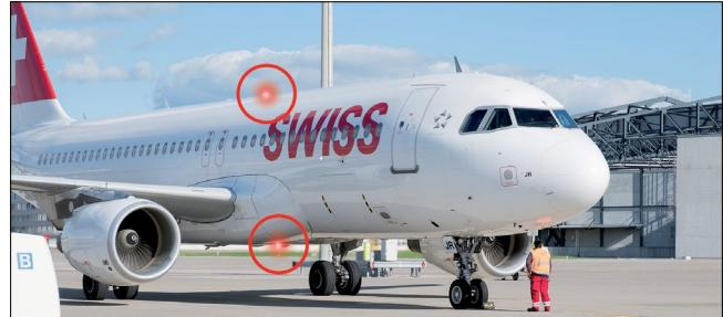
Sobald die roten Blinklichter (Beacons) oben und unten am Flugzeug eingeschaltet sind, könnten die Radkeile demnächst entfernt werden. Die Durchfahrt vor dem Flugzeug ist mit **erhöhter Vorsicht** noch erlaubt
