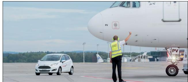
Ab dem Zeitpunkt, ab dem die Radkeile entfernt sind, ist die **Durchfahrt** vor und hinter dem Flugzeug **verboten**. Das Handzeichen «Daumen hoch» gilt dem Piloten.
