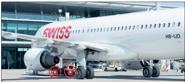
Sind die Warnblitzleuchten am Pushback-Traktor eingeschaltet, ist die **Durchfahrt** hinter dem Flugzeug **verboten**.
