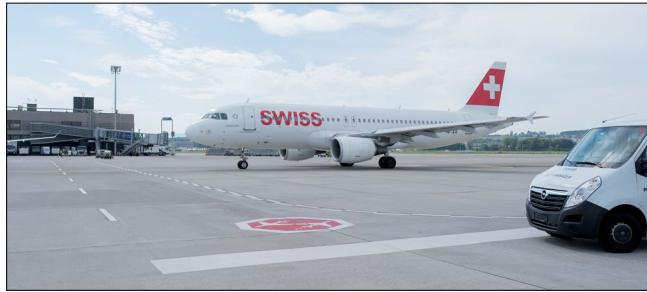
Versetzte Straßenrandlinien signalisieren, dass die Fahrstrasse über einen Rollweg führt. Halten Sie niemals auf einer Fahrstrasse, welche über einen Rollweg führt (vergleichbar mit einem Bahnübergang).
