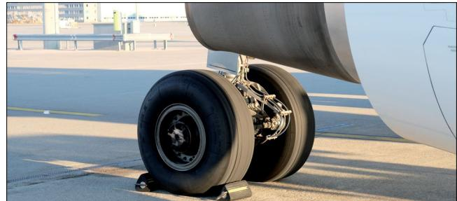
Solange das Flugzeug mit Radkeilen (Chocks) gesichert ist, ist die **Durchfahrt noch erlaubt**. Achten Sie hinter dem Flugzeug immer darauf, ob die Triebwerke eingeschaltet sind.
