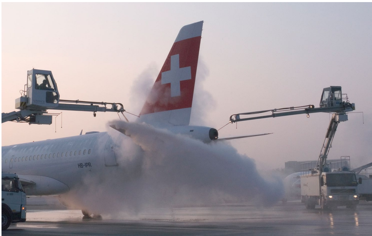
Flugzeugenteisung auf dem De-Icing-Pad
