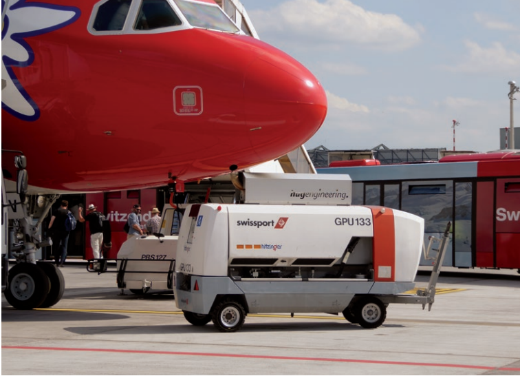
Auf dem Dach des GPU ist ein Partikelfilter montiert.
