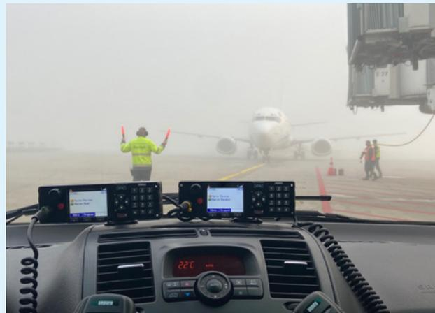
Einweisen eines Flugzeuges bei Ausfall des Dockleitsystems aufgrund von Nebel
