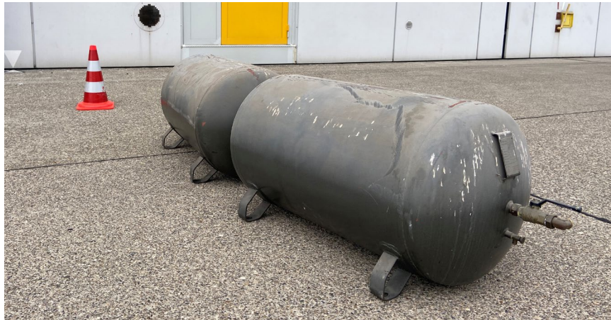
Die alten Druckluftbehälter sind ausgebaut. Die neuen Sirenen benötigen keine Kompressoren mehr, da sie ohne Druckluft betrieben werden.
